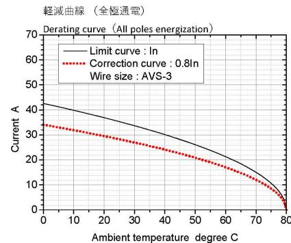
備考：軽減曲線 作成手順は IEC 60512-5-2 TEST 5-b による
