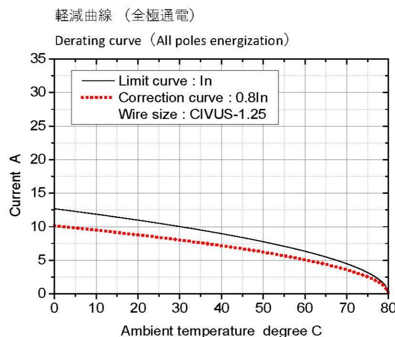
備考：軽減曲線 作成手順は IEC 60512-5-2 TEST 5-b による
